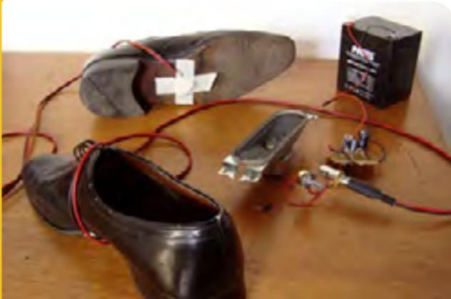
Figura 8: Zapatófono (Sapato com salto de madeira. Observe que se evita grudar o piezo numa parte que entrará em atrito direto com o chão, uma vez que isto resultaria num som muito agressivo, além de talvez danificar o captador). Fonte: <https://sonidocinico.files.wordpress.com/2014/10/zapatc3b3fonos-01-1.jpg>
